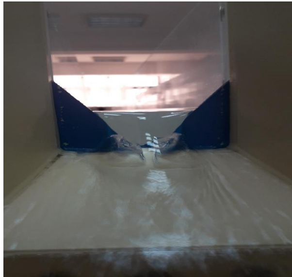
Photographie III.6. d'un déversoir triangulaire à contraction complète
