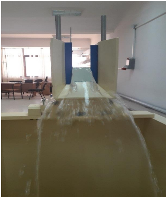
Photographie III.8. d'un déversoir rectangulaire à contraction complète
