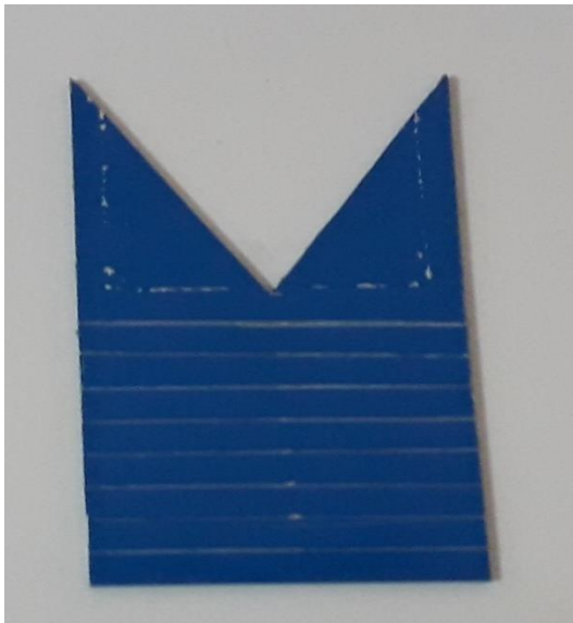
Photographie III.6. d'un déversoir triangulaire à contraction complète
