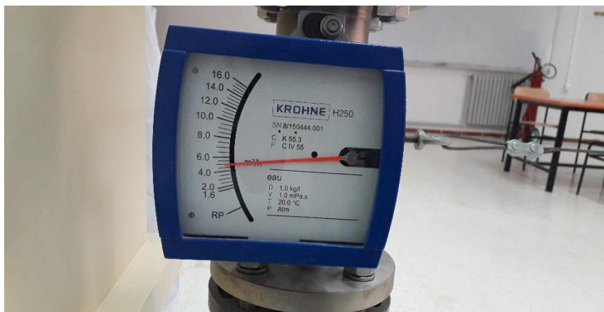
Photographie III.5. vue du tube de mesure de volume
