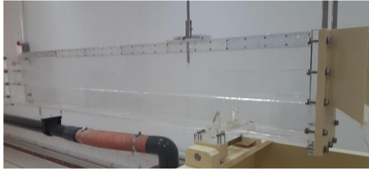
Photographie III.4. photo du limnimétrie et du déversoir mises en expérience
