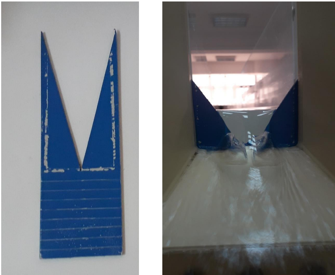
Photographie III.7. d'un déversoir triangulaire à contraction complète
